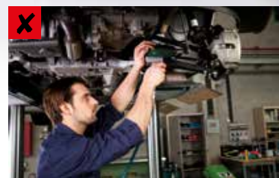
Klucz pneumatyczny może spowodować uszkodzenie połączenia oraz obniżyć jego parametry robocze.
