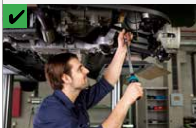
Należy używać klucz dynamometryczny do dokręcenia części z właściwą siłą.
