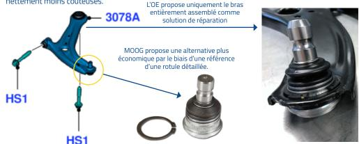
Néanmoins, ce type de joint à rotule ne peut être remplacé indéfiniment. En effet, les opérations répétitives de démontage/pressage affectent de manière significative le diamètre et la rondeur du trou du bras dans lequel la rotule est pressée, en particulier lorsque le corps du bras est en tôle d'acier.
