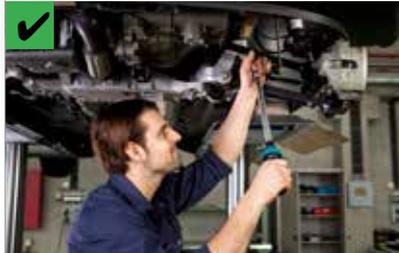
*Verwenden Sie für den korrekten Anzug des Teils einen Drehmomentschlüssel.*
