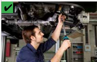
Utilice una llave dinamométrica para fijar la pieza de forma correcta.
