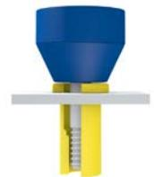
2. Placez l'outil muni de l'écrou dans le trou percé du triangle de suspension.
