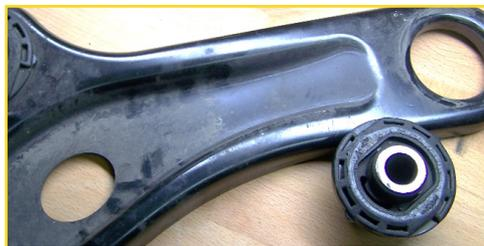
Ainsi, même si ces bagues en plastique sont bien maintenues en place tant que le véhicule est dans des conditions normales, un choc important (tel qu'un nid de poule ou autres) peut provoquer une force telle qu'elle fait sortir la bague en plastique de son alésage.
