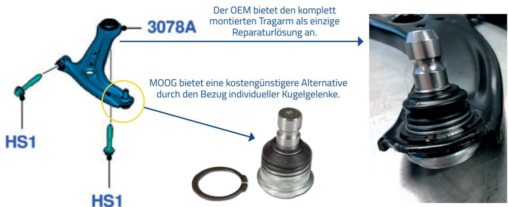
Wichtig ist, dass Kugelgelenke nicht unbegrenzt ausgetauscht werden können. Wiederholte Demontage-/Pressvorgänge beeinträchtigen sowohl den Durchmesser als auch die Rundheit der Bohrung im Tragarmkörper - wo das Kugelgelenk eingepresst wird - erheblich. Dies ist insbesondere dann der Fall, wenn das Material des Tragarmkörpers aus Stahlblech besteht.
