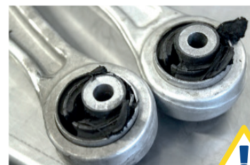
Desgaste prematuro de los bujes del brazo estabilizador de suspensión.
