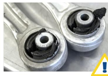
Usure prématurée des joints du bras de suspension
