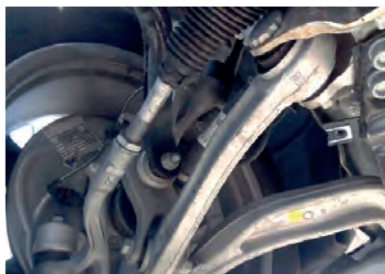
Dokręcone tuleje wahaczy poprzecznych z "wiszącymi" kołami (rys. A).
